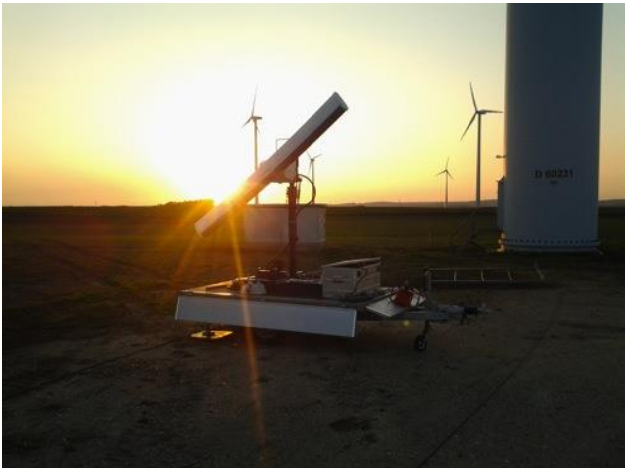
Abbildung 5-2: Ausrichtung des Radars im Vertikalbetrieb – der Radarbalken dreht sich normal zur Erdoberfläche (Radarstandort bei Zistersdorf / Götzendorf während des ersten Erfassungsdurchgangs; 17.-18. September 2014).
