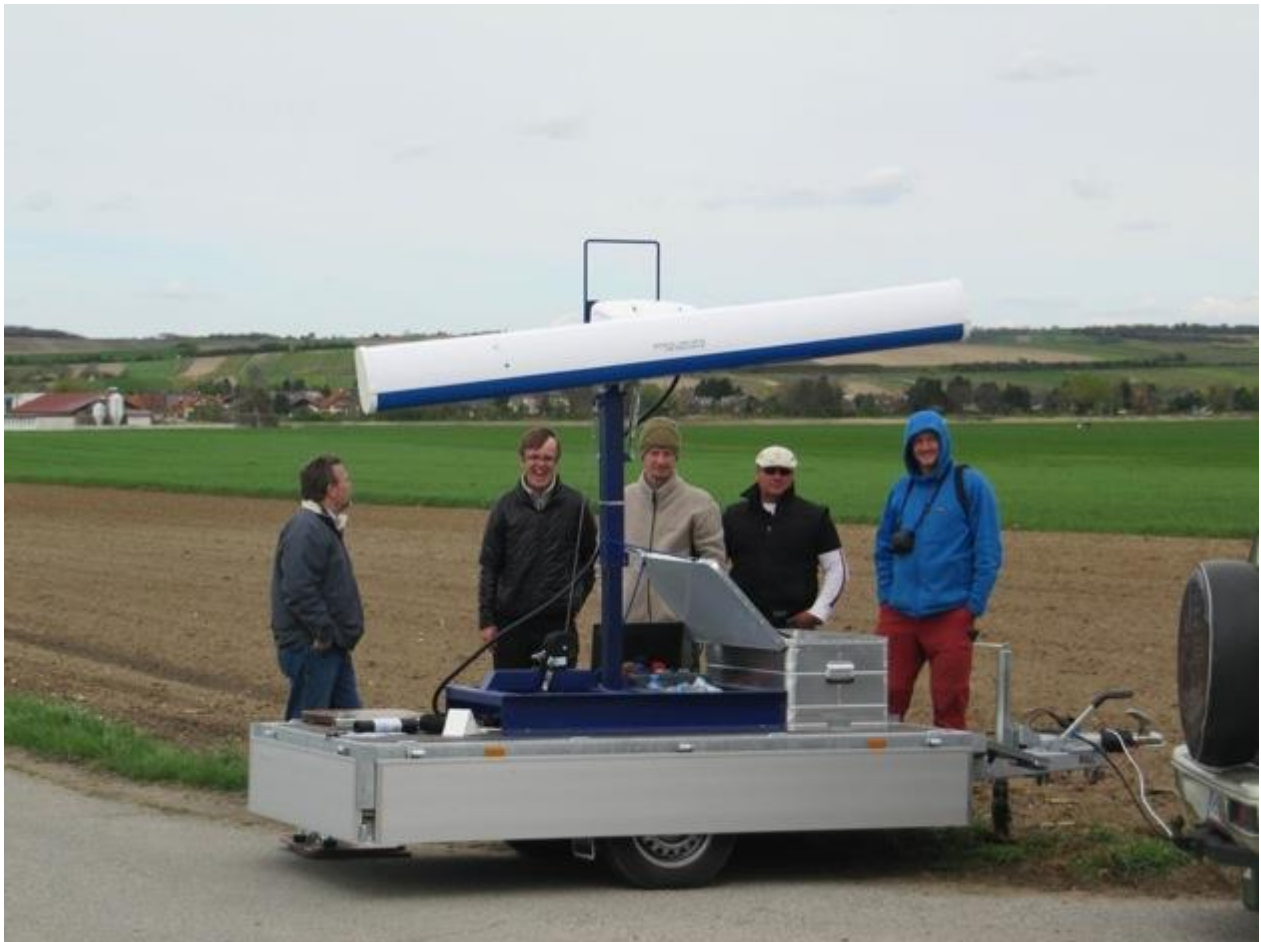
Abbildung 4-1: Modifiziertes kippbares und für den Landgebrauch geeignetes transportables Radargerät der Marke Furuno mit einer 8 ft Balkenantenne (v.l. J. Eiersberg – Furuno Vertretung Österreich, J. Hill – Avitec Research, M. Bierbaumer, H. Jaklitsch, S. Wegleitner – alle Projektteam).
