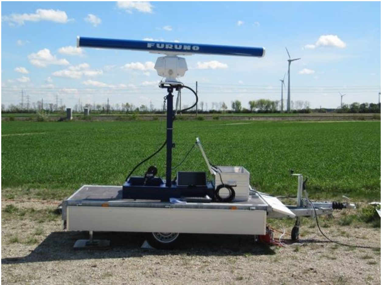
Abbildung 5-1: Ausrichtung des Radars im Horizontalbetrieb – der Radarbalken dreht sich, wie vom Schiffsbetrieb bekannt, in einer Ebene über dem Grund.
